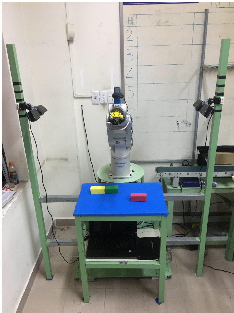
Hình 5.16. Bàn làm việc của tay máy sau khi hoàn thành.
