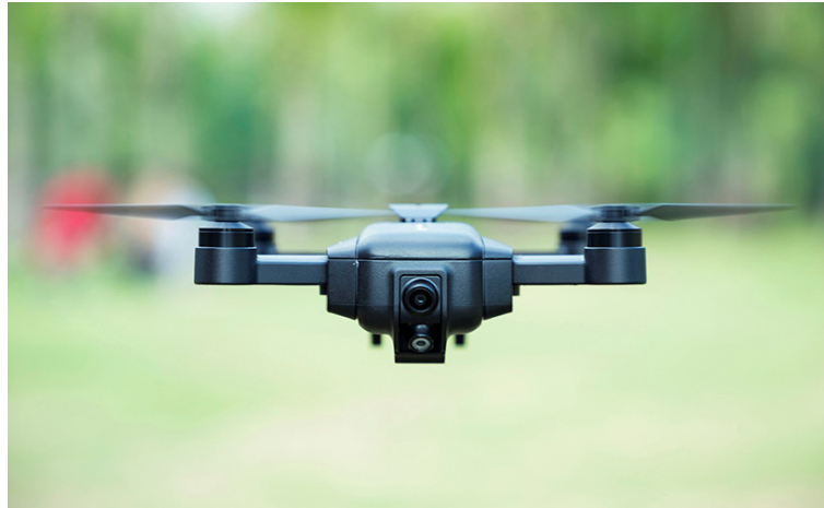
Hình 1.2. Flycam Mark sử dụng hệ thống định vị tích hợp thị giác quán tính
