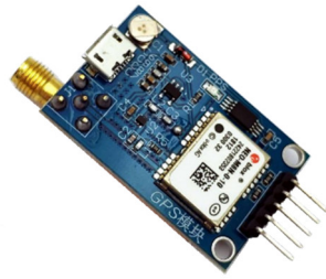
Hình 5.3. GPS Receiver Ublox NEO-M8N
